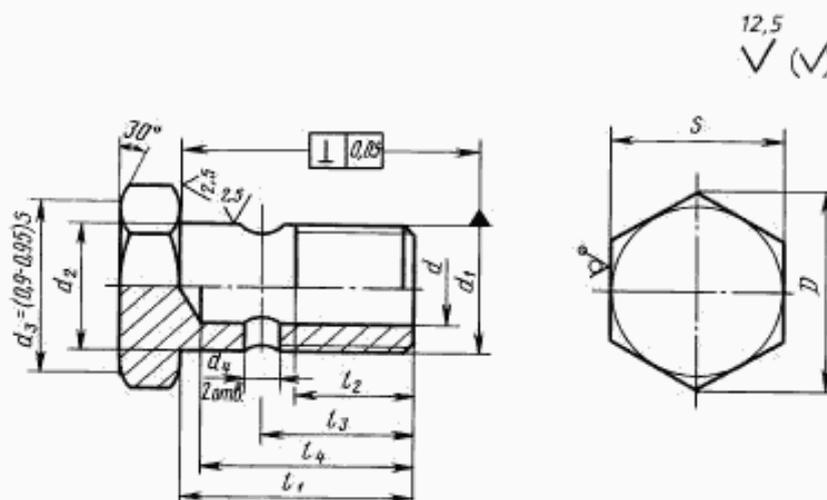
Примечание. Допускается изготавливать болты с отверстием без конуса от инструмента.
